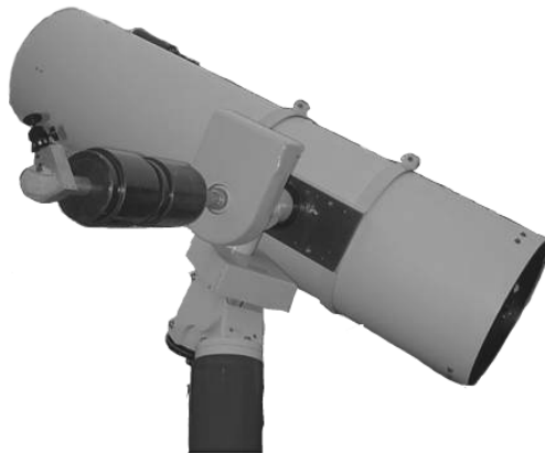
Abbildung 2: 440 mm Newton-Reflektor der Sternwarte Buchloe.
