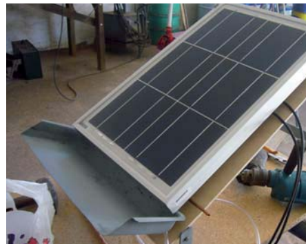
Abb. 37: Kuchenblech als Auffangschale
