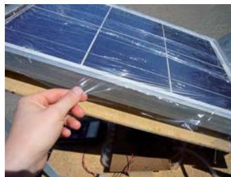
Abb. 27: Folie beim Aufziehen auf die Solarzelle
