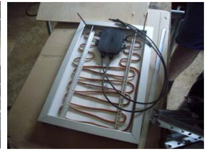
Abb. 62: Kühlkreislauf hinter der Zelle mit Metallschienen fixiert
