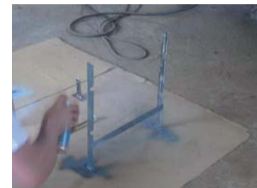
Abb. 15: Einsprühen des Gestells mit Zinkspray
