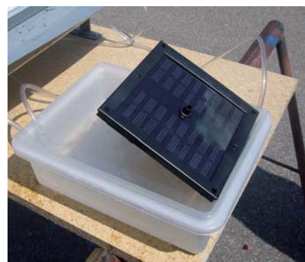
Abb. 39: Solarzelle der Wasserpumpe auf dem Wasserbehälter
