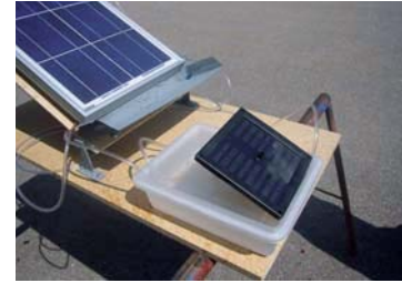
Abb. 14: Nahaufnahme der Solarzelle der Pumpe
