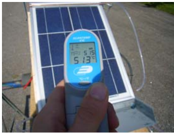
Abb. 69: Oberflächentemperatur vor dem Versuch
