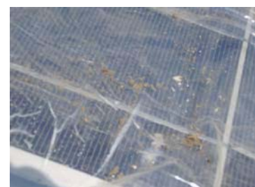
Abb. 33: Verschmutzung der Folie
