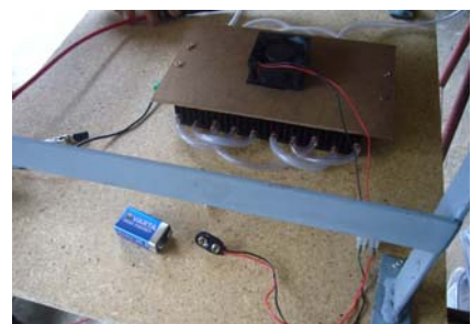
Abb. 66: Wärmetauscher mit Kühl- leitungen und Ventilator
