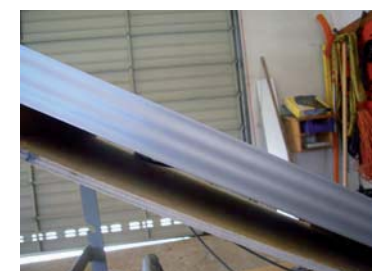
Abb. 17: Zwischenraum von Solarzelle und Aufliegefläche
