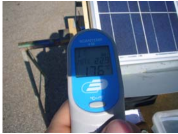
Abb. 56: Oberflächentemperatur vor dem Versuch
