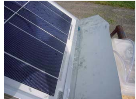
Abb. 51: mit Wasser gefüllte Auffangschale
