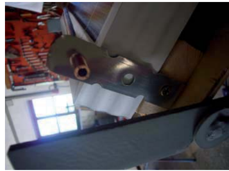
Abb. 36: Metallplättchen als Halterung der Schiene
